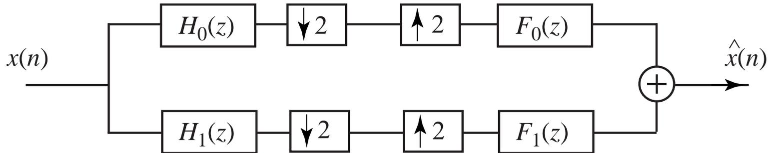
$$\hat{X}(z) = \frac{1}{2}[F_0(z)H_0(z) + F_1(z)H_1(z)]X(z) + \frac{1}{2}[F_0(z)H_0(-z) + F_1(z)H_1(-z)]X(-z)$$
